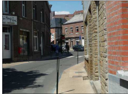
Figure 515 : Photographie d'un revêtement de sol différent suivant les usages, potelets anti-stationnement, dans le centre de Rebecq
